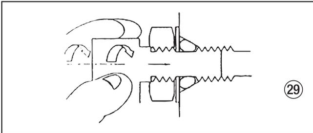
4. Reculez le raccord d'un tour complet au plus afin de l'aligner, au besoin.
