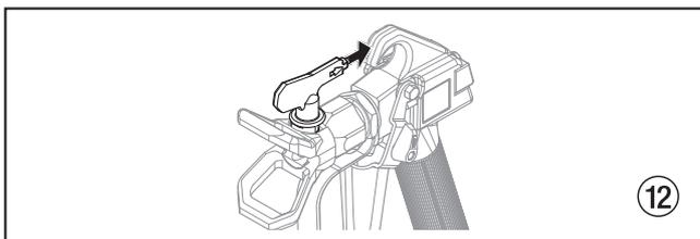
3. Appuyez une fois sur la détente du pistolet pour que la pression débouche la buse. N'appuyez JAMAIS deux fois de suite sur la détente lorsque la buse est dans la position inversée. Cette procédure peut être répétée jusqu'à ce que la buse ne soit plus obstruée.
