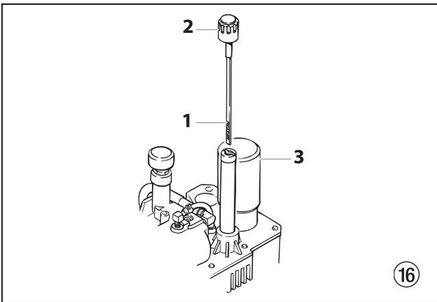
2. Changez le fluide hydraulique tous les douze mois. Drainez l'ancien fluide du réservoir et remplissez-le de 5,9 (6,25 qt.) litres de fluide hydraulique. Faites marcher le pulvérisateur à une pression suffisante pour faire fonctionner la section des liquides. Faites tourner le pulvérisateur à basse pression pendant 5 minutes. Cela permet d'évacuer l'air du système. Vérifiez le niveau du fluide au terme de cette procédure. Ne remplissez pas trop le réservoir.
