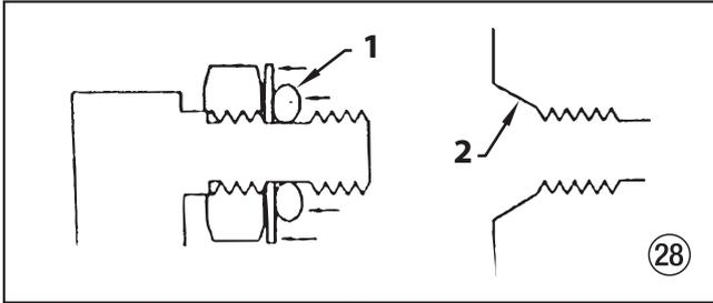
3. Serrez le raccord jusqu'à ce que la rondelle pousse le joint torique dans l'ouverture et que ce dernier soit plat contre l'ouverture. (Ne le serrez pas davantage! - serrez uniquement le raccord à la main afin de comprimer le joint torique dans l'ouverture!)
