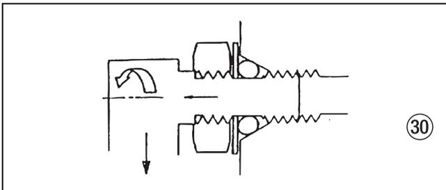
5. Serrez l'écrou au couple en retenant le raccord (3). Cela devrait exposer un espace (4) derrière l'écrou qui peut agir comme indicateur que le raccord est bien fixé. (Il s'agit d'une caractéristique d'un type précis de ce raccord précis uniquement - qui se visse dans la tête du cylindre. Les autres raccords, tels que ceux utilisés sur la pompe hydraulique, s'assemblent de la même manière, mais n'ont pas l'indicateur.)
