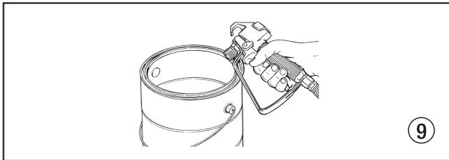
14. Déclenchez le pistolet dans le conteneur de déchets en métal jusqu'à ce que le solvant usagé soit vidangé et que du solvant frais sorte du pistolet.
